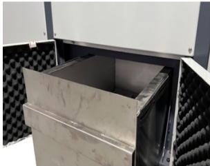
全封闭废料仓
